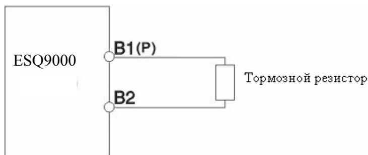
B1, B2 – это клеммы подлежащие соединению с тормозным резистором. Пожалуйста, не подсоединяйте тормозной резистор к другим клеммам, иначе он испортится, перегреется и сгорит.
