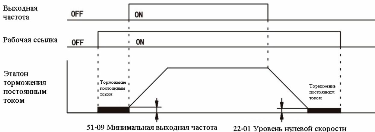
**Схема последовательности сигналов эталона торможения постоянным током.**
