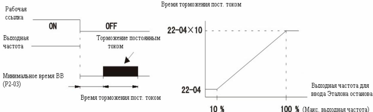
Если Эталон остановки введен, по истечении минимального времени базовой блокировки (P2-03), останов будет выполнен с помощью торможения постоянным током.
