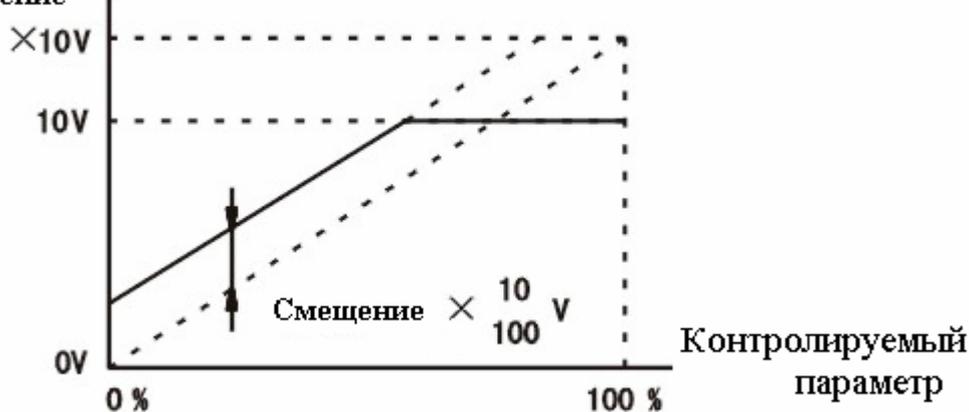
Регулировка для контроля вывода
