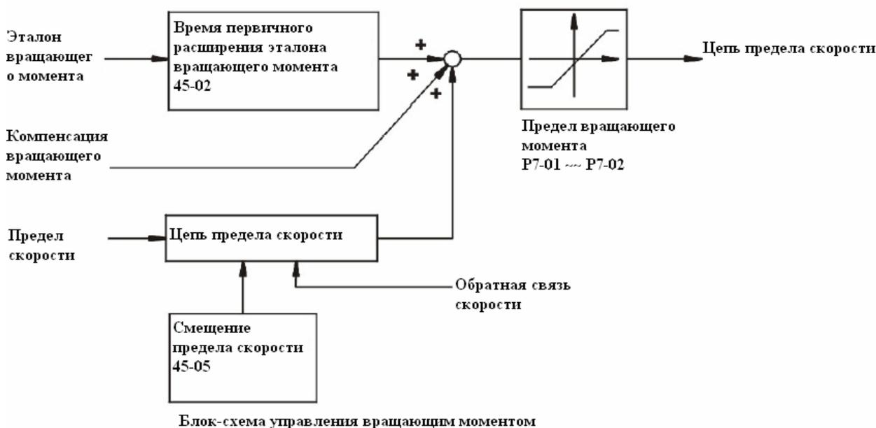
При использовании управления скорости/функции переключения управления вращающим моментом, пожалуйста, установите параметр 45-0 в "0" (управление скоростью).
