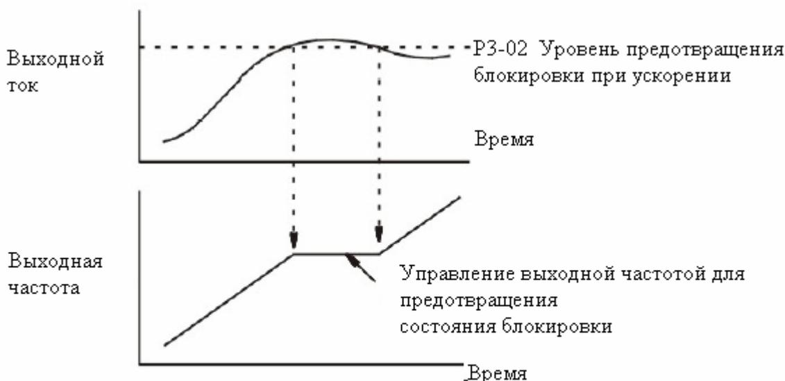
**Функция предотвращения блокировки при ускорении (случай, когда P3-01=1)**
