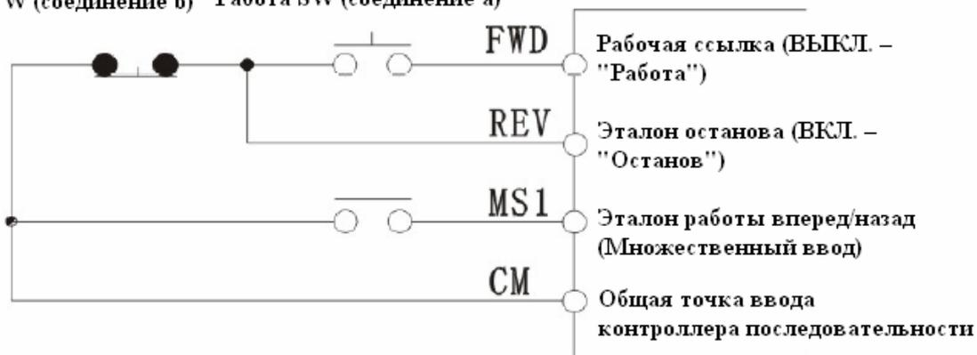
Пример прокладки проводов 3-проводной системы
