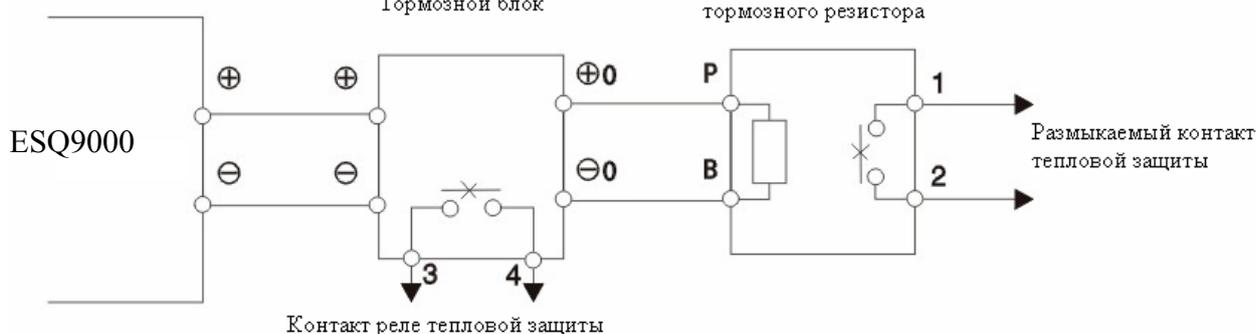
Соединение блока тормозного резистора/тормозного блока
