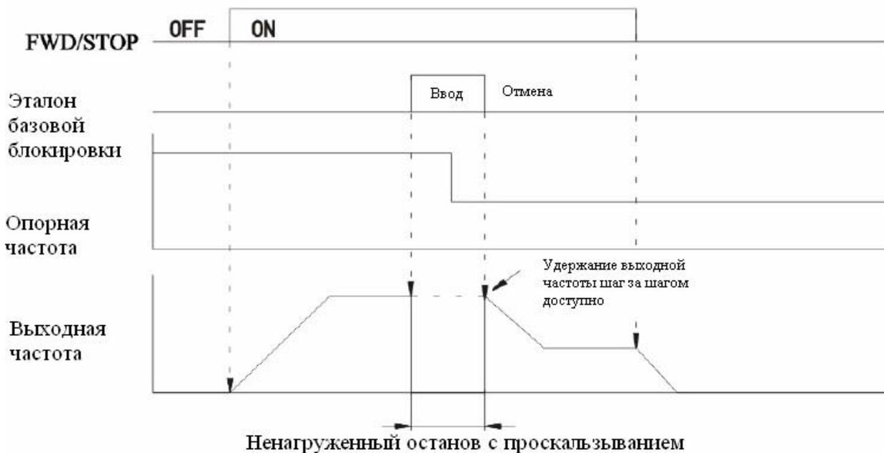
Выходная частота, которая может удерживать состояние пошагового изменения
