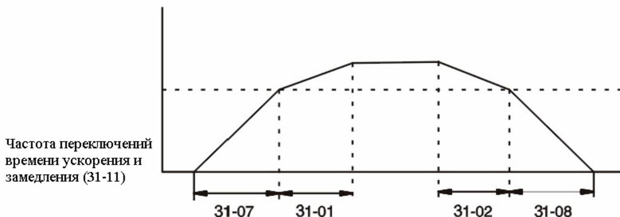
Если выходная частота  $\geq 31-11$ , работа будет происходить со временем ускорения/замедления 31-07, 08.
