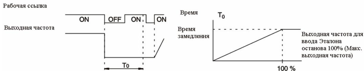
После ввода Эталона останова, перед "временем  $T_0$ ", рабочая ссылка будет игнорироваться. "Время  $T_0$ " будет определяться выходной частотой и временем замедления.
