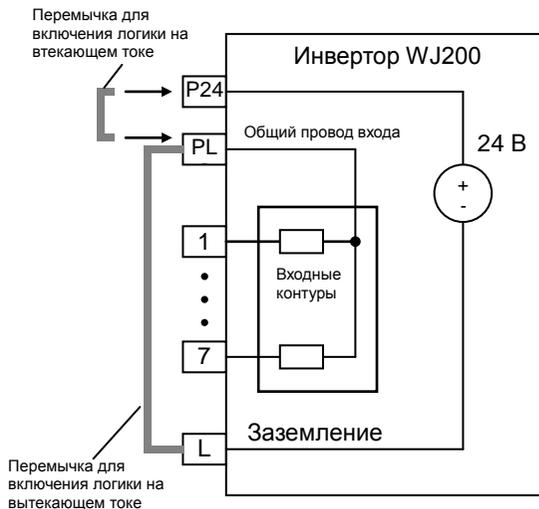
На схеме электрических соединений на следующей странице показаны четыре комбинации использования входов с вытекающим или втекающим током и использования внутреннего или внешнего источника электропитания постоянного тока.
