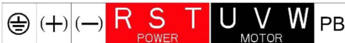
Обозначение контакта трехфазной основной цепи на 11 кВт
