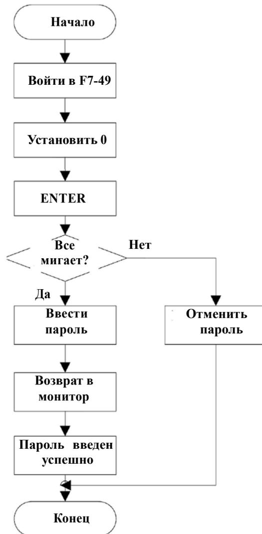
Рисунок 4-4. Процедура установки пароля
